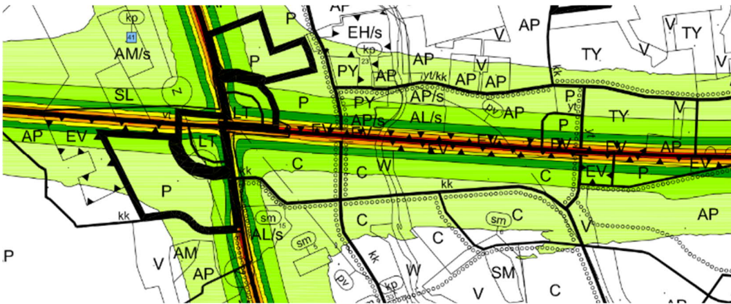
Kuva 17. Liikennemelu, ennustetilanne, yö. 45 dB:n raja on tumman vihreän ja keskivihreän raja. Lähde: Euran kunta, Keskustan osayleiskaavan meluselvitys (FCG Suunnittelu ja tekniikka Oy, 2015).
